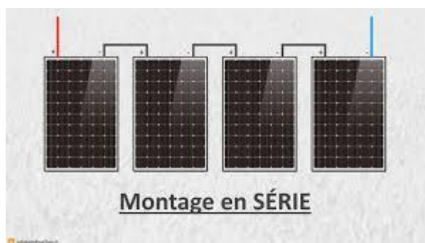
Figure I 5:Raccordement des panneaux solaires série.
