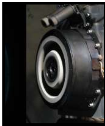
Figure I.1. Propulseur à effet Hall
