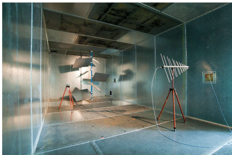
Fig.II-20. Photographie de la chambre réverbérante [3]
