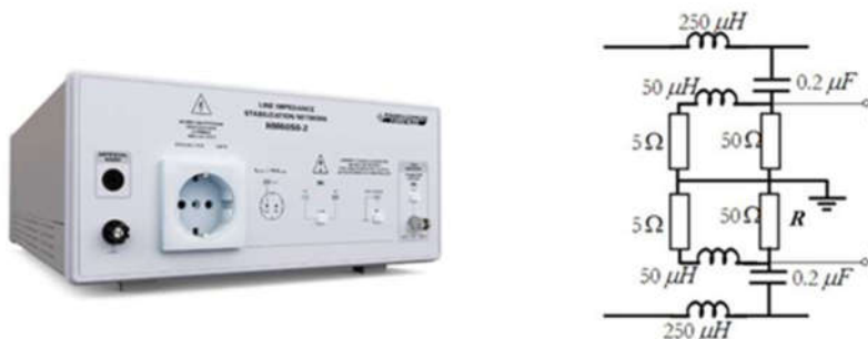
Fig.II-8. Structure du Réseau Stabilisateur d'Impédance de Ligne (RSIL) [24]
