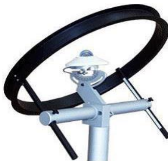
Figure I.9 Pyranomètre muni d'une bande pare-soleil [28].
