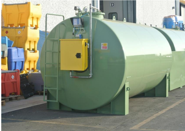
Figure I.7 : Réservoir à double paroi [14]
