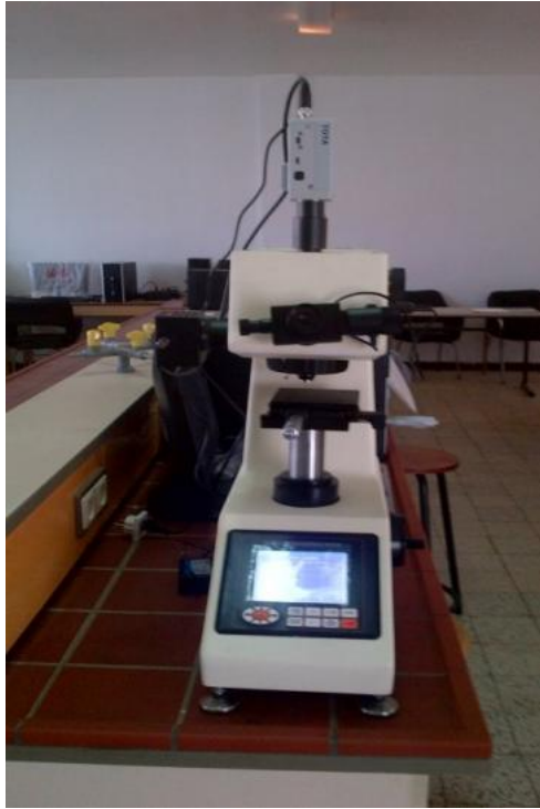
Figure III.2 : Essais mécaniques microdureté vickers au niveau de Laboratoire Elaboration et Caractérisation Physico Mécanique et Métallurgique des Matériaux, (ECP3M).
