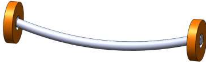
Figure I.3. Représentation d'un rotor flexible.
