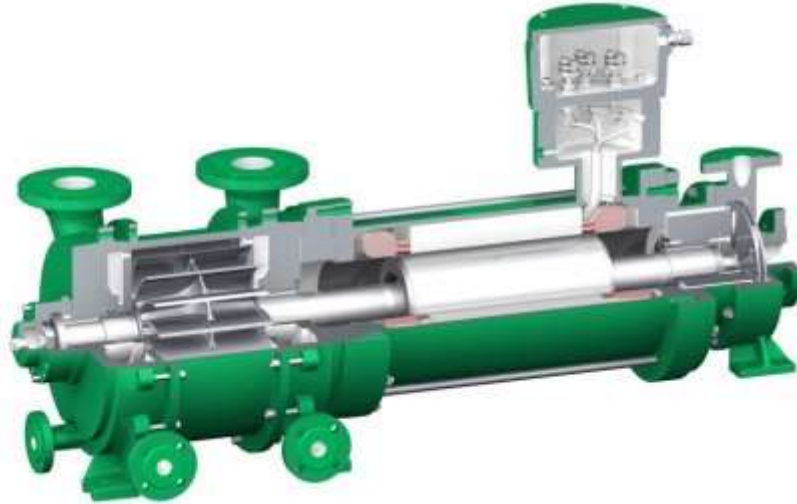
Figure I.7. Pompe à rotor.
