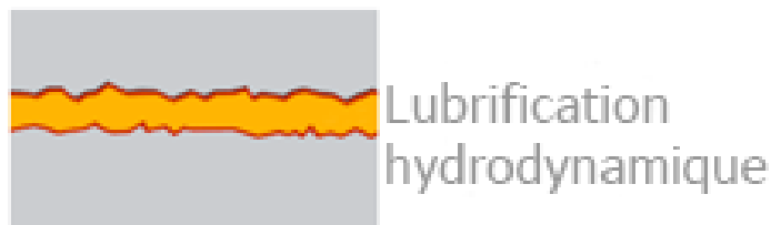
Figure II.9 : Illustration du film fluide dans la lubrification hydrodynamique.
