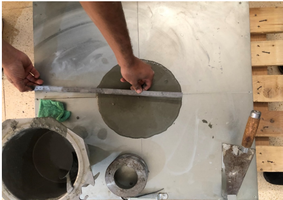
Figure 4.7 Essai d'étalement cône
