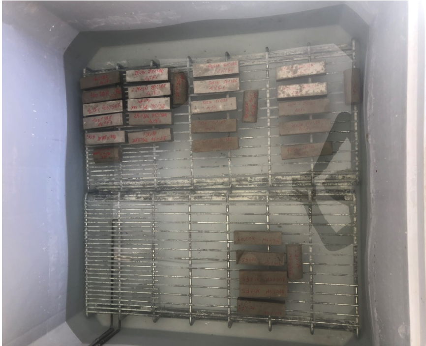
Figure 4.9 Bac d'eau pour la conservation des éprouvettes.
