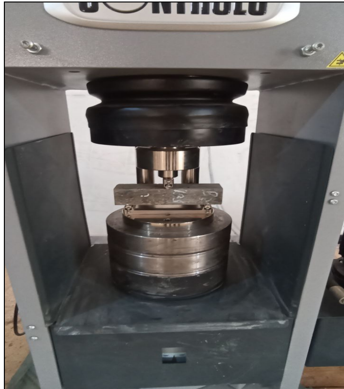
Figure 4.10 Essai et dispositif de flexion par trois points
