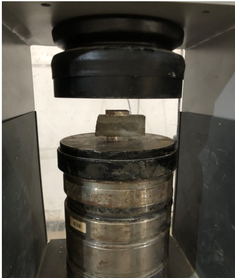
Figure 4.11 Essai du dispositif de compression simple
