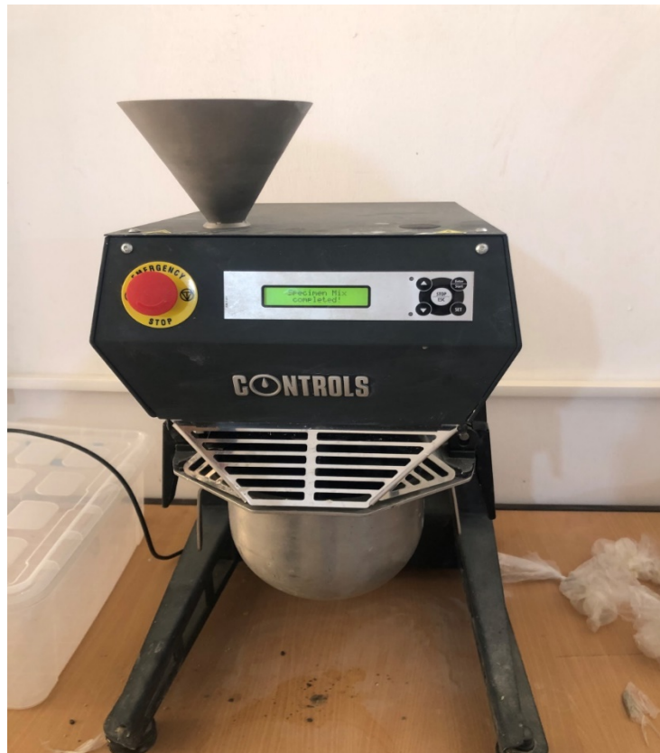
Figure 4.6 Appareillage pour l'essai d'équivalent de sable
