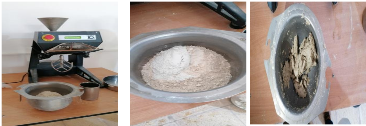
Figure III.2 : Les différentes étapes réalisées pour la préparation des pâtes (ciment/diatomite).
