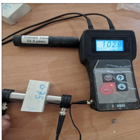
Figure III.6 : Montage de l'essai ultrasonique.
