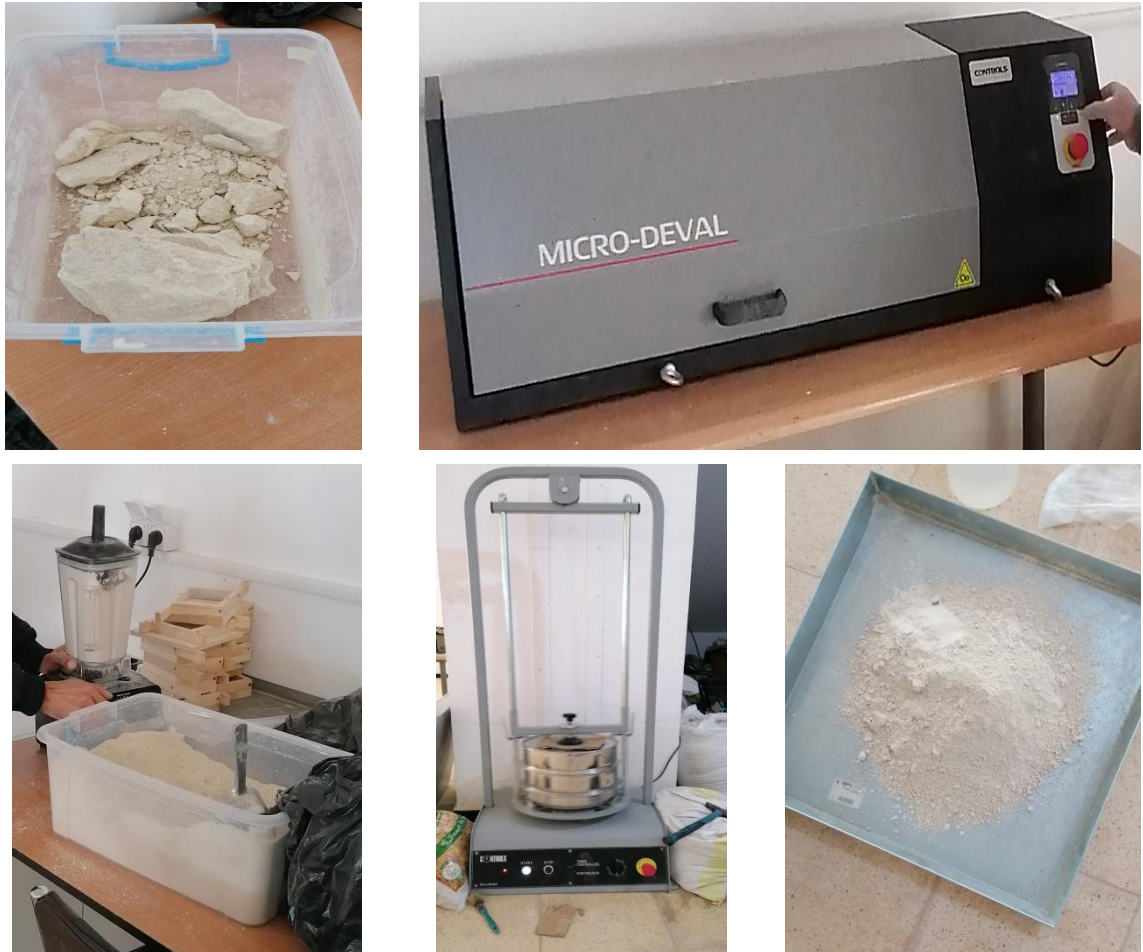
Figure III.3 : Les différentes étapes réalisées pour la préparation de la diatomite
