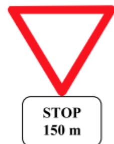
A24- Arrêt à 150 m
