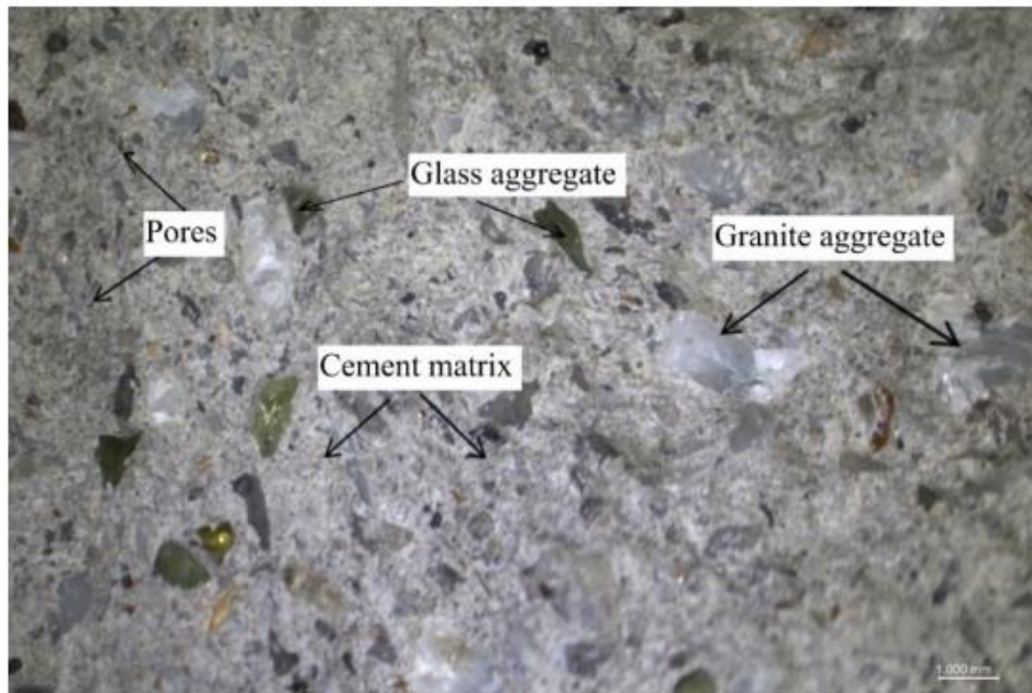
FigureII.13. Images au microscope optique de la microstructure du mortier
