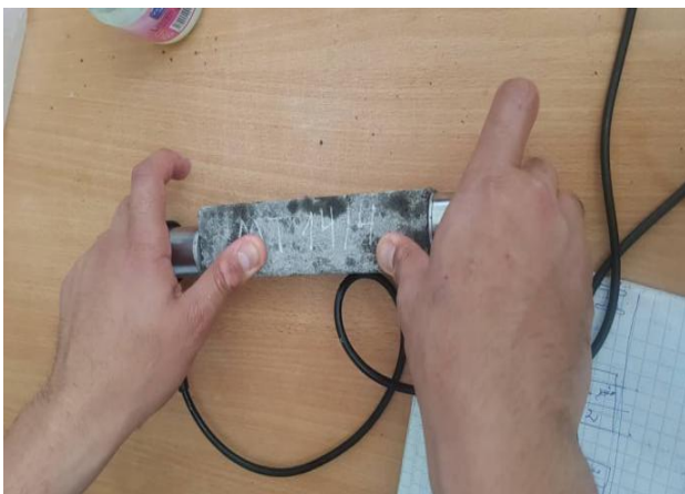
FigureII 17 : Vitesse de propagation d'ondes ultrasonique
