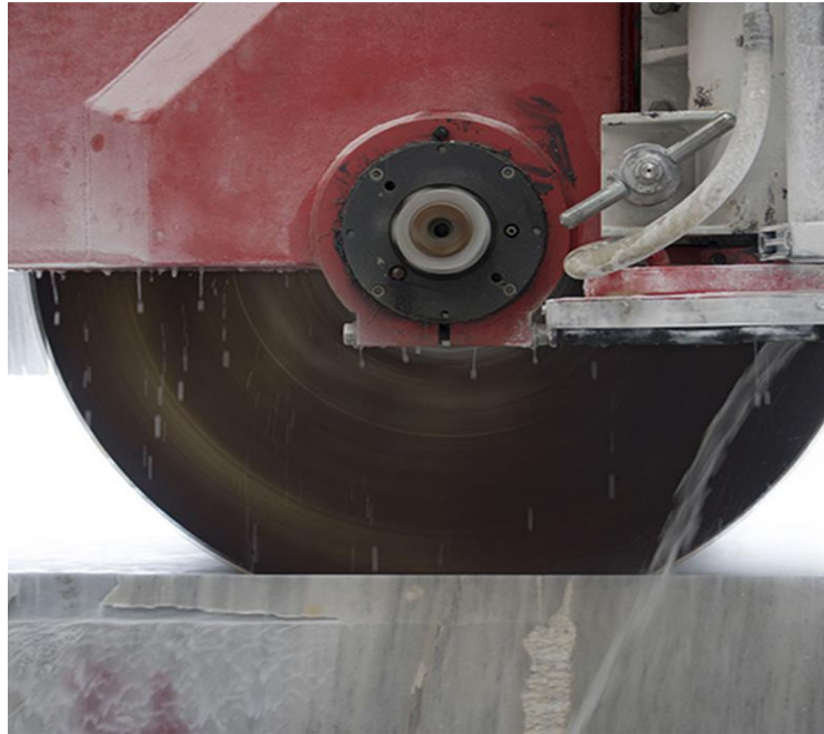
Figure II. 6 : Machine de Coup et Ébarbage [19].
