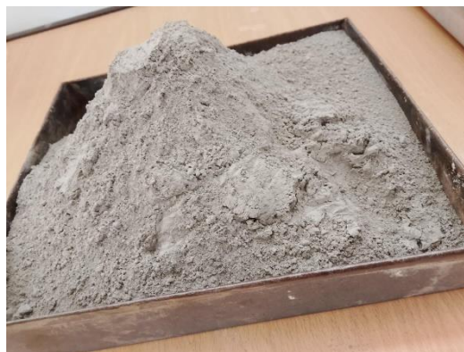
Figure III. 5 : Les fines provenant des déchets de granite
