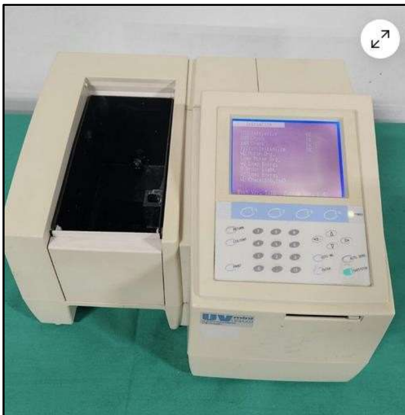
Figure III.21 : Un spectrophotomètre UV visible (Chimadzu UV- mini1240). [1]
