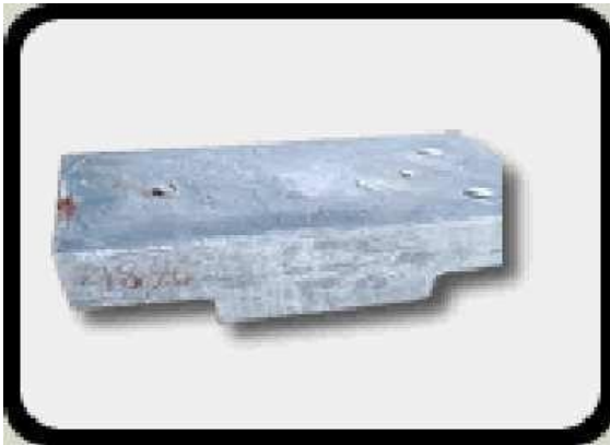
Figure I-6: zinc jumbo de 02 tonnes cathodique : plaque de 120kg
