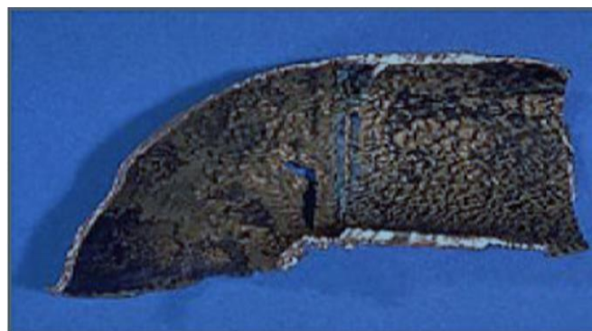
Figure I.8: Étapes de développement du phénomène de corrosion-érosion [50].
