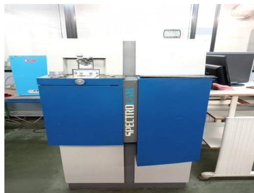
La composition d'Acier C45 par appareil de spectro-lab
