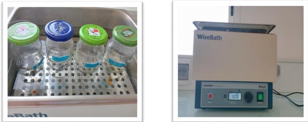
Figure II. 14-15 : Placer les échantillons dans le bain-marie.
