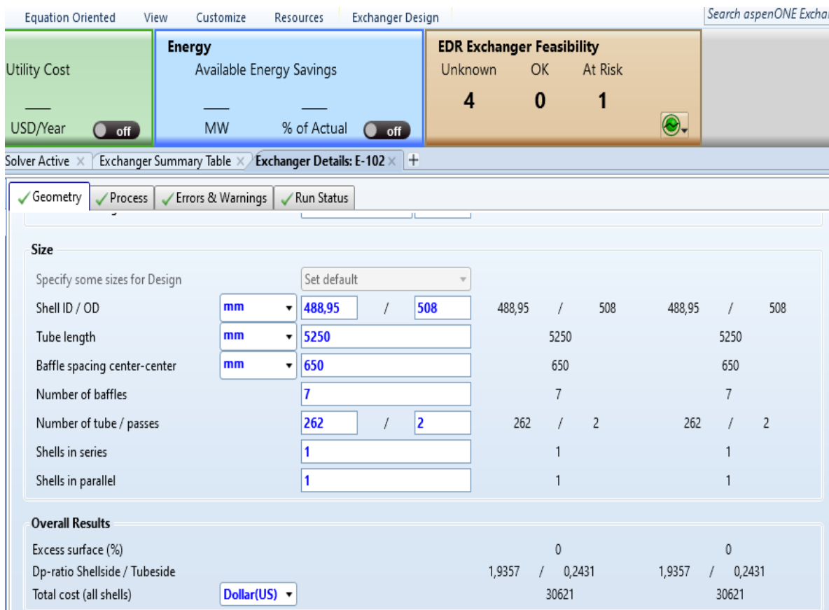
Figure 3-9 : Estimation du coût de l'échangeur tube calandre réalisée par Aspen EDR.
