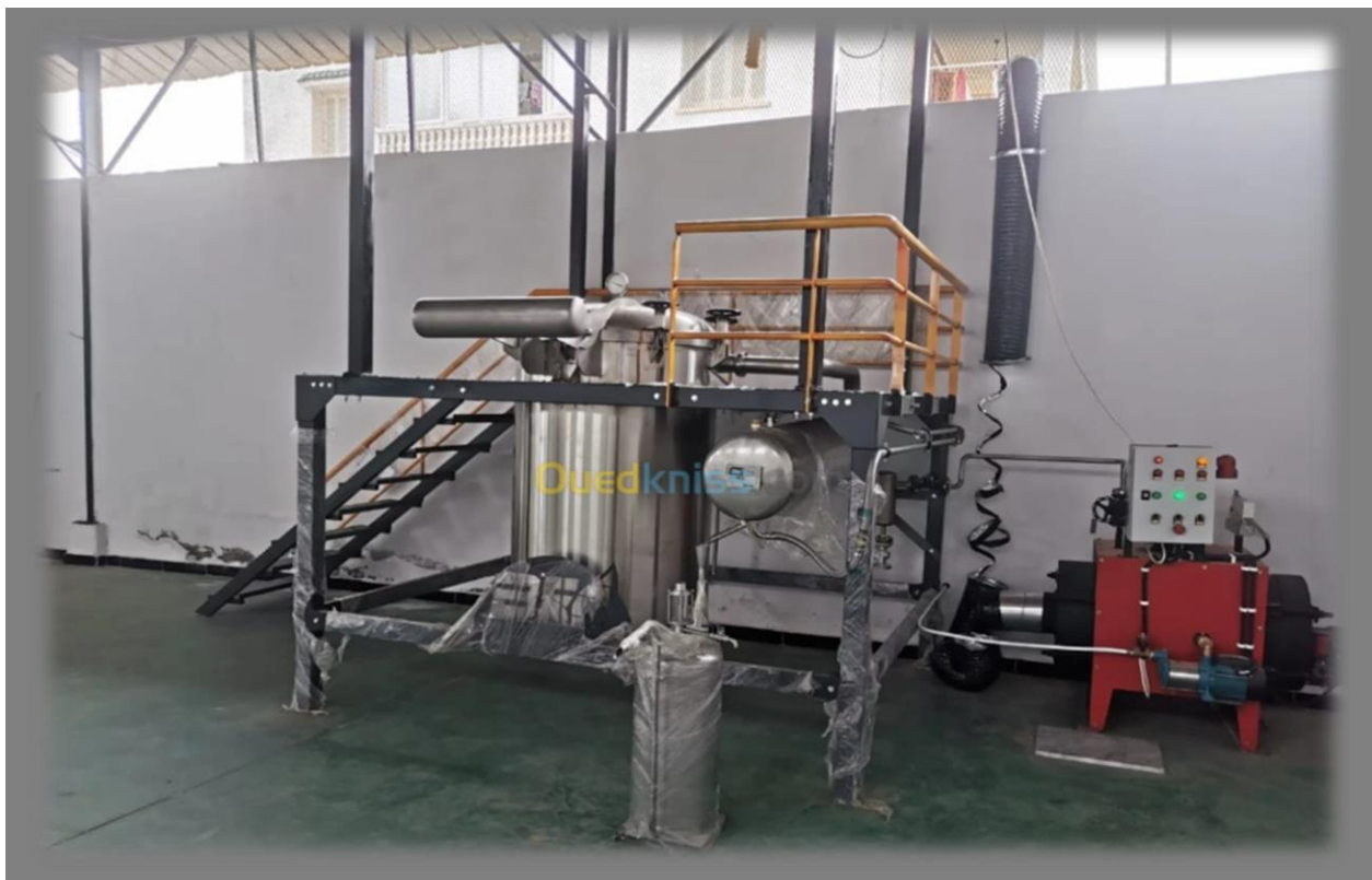
Figure 10 : Schéma d'un alambic distillateur pour huiles essentielles (vapo-distillation)
